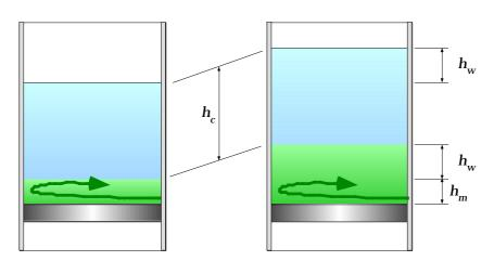
FIGURE 4.4 – DETERMINATION OF ACTUAL MIXING HEIGHT
