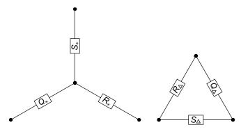
$$R_* = rac{Q_\Delta S_\Delta}{R_\Delta + Q_\Delta + S_\Delta}$$
